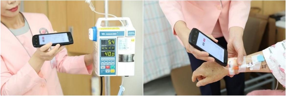
이동형의료장비 위치 및 사용정보를 PDA와 연동하는 모습. PDA로 환자에게 사용할 의료장비를 태그한 후(왼쪽) 환자 팔찌에 있는 바코드를 태그하면(오른쪽), 사용시간 및 환자 정보 등이 자동으로 기록된다.
